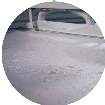
**FIGURE 6. Fibres obtenues de contenants multicouches et d'autres matières fibreuses nettoyées afin de retirer les dernières impuretés**
